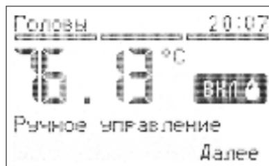
Кнопка ОК переключает состояние клапана, кнопки Вверх/Вниз выходят из режима ручного управления клапаном.
