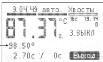
Этап “Хвосты” содержит параметр “Температура”. Параметр устанавливается в настройках (от 70 до 100) и может быть изменен во время выполнения программы. На этом этапе при превышении значения текущей температуры более значения параметра “Температура” клапан закрывается, выполнение программы прекращается. Если надо продолжить выполнение этого этапа, достаточно отредактировать параметр “Температура” до значения выше текущей температуры.
