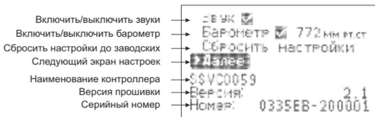
**Звук.** При включенных звуках, при завершении этапов “Тело” и “Хвосты”, контроллер синхронно с миганием подсветки дисплея издает звуковые сигналы для привлечения внимания. Сообщения и звуки не выдаются при активности пользователя (если нажимаются кнопки) и в ручном режиме. При включенных звуках издаются звуковые сигналы ошибки датчика температуры, оповещения о завершении этапа и т.д.
