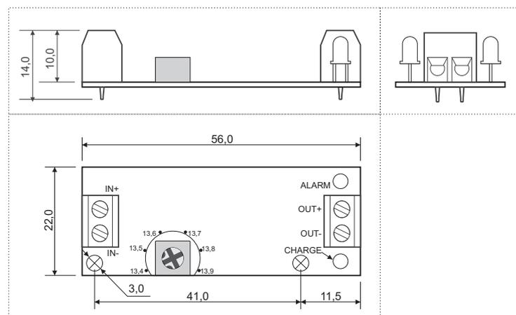
**Рис. 3. Регулировка напряжения окончания заряда**
